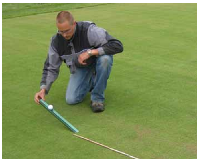
Bilde 4. Måling av ballrull i forsøk med Primo MAXX på green. Fordi rutene ikke er mer enn 2 m lange brukes vanligvis et forkorta stimp-meter. Foto:Trygve S.Aamlid.
