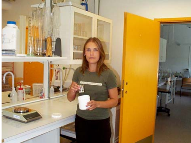
Bild 1. Mikroorganismernas aktivitet i marken kan bestämmas genom att mäta den koldioxid som avges då de bryter ner organiskt material. I laboratoriet visar Lina Lundström hur dessa mätningar utförs i täta burkar som innehåller ett jordprov och natriumhydroxid. Foto: Thomas Andersson.
