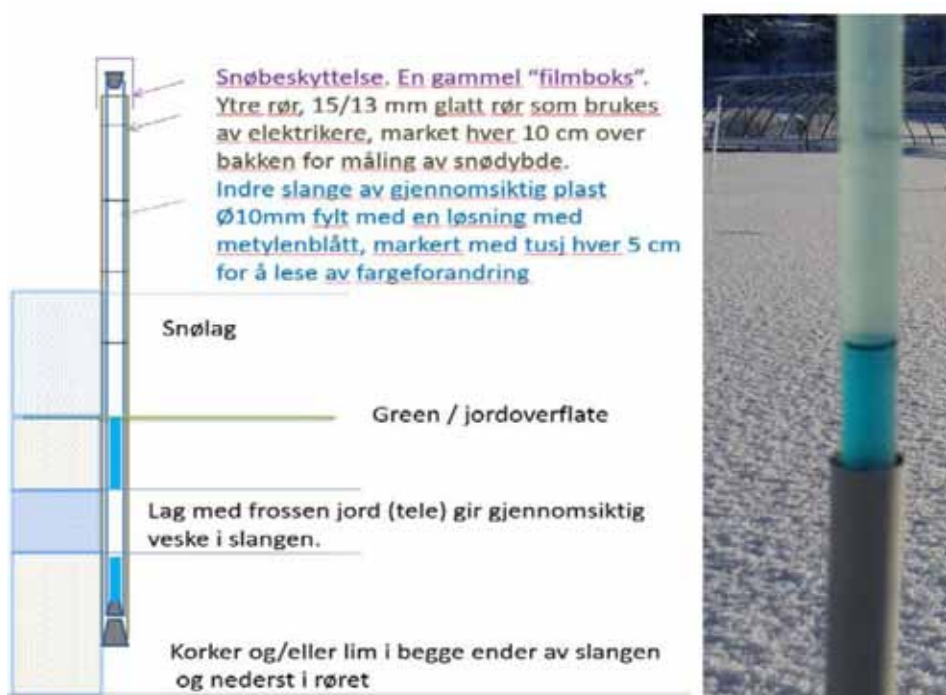
Figur 1. Kombineret udstyr for måling af snetykkelse og frostdybde. Foto: Trond Pettersen
